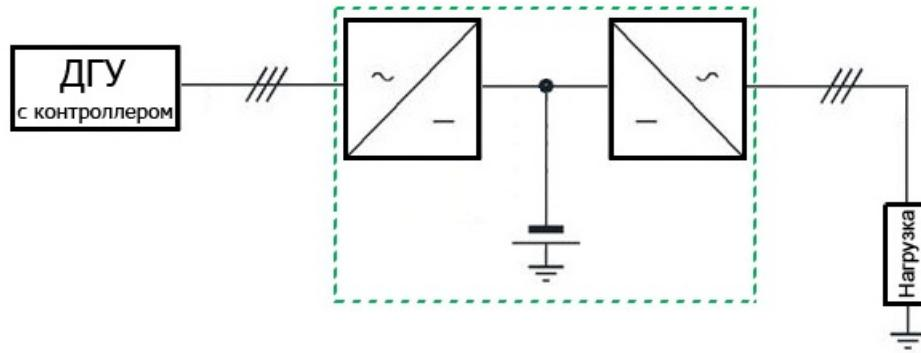
При работе ИБП от ДГУ возможно использование режима плавной передачи мощности с инвертора на ДГУ при скачкообразном изменении нагрузки.
