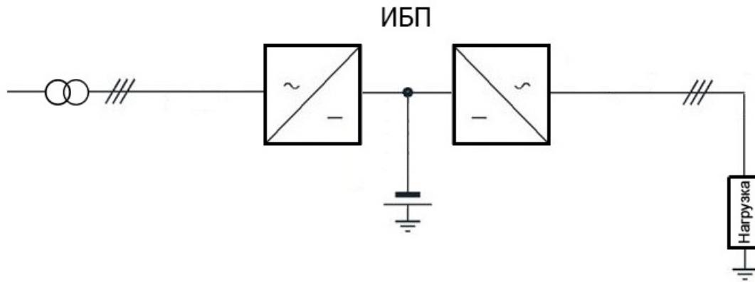
При необходимости существует возможность питания нагрузки стабилизированной частотой. В этом режиме выходная частота ИБП не зависит от изменения входной частоты.
