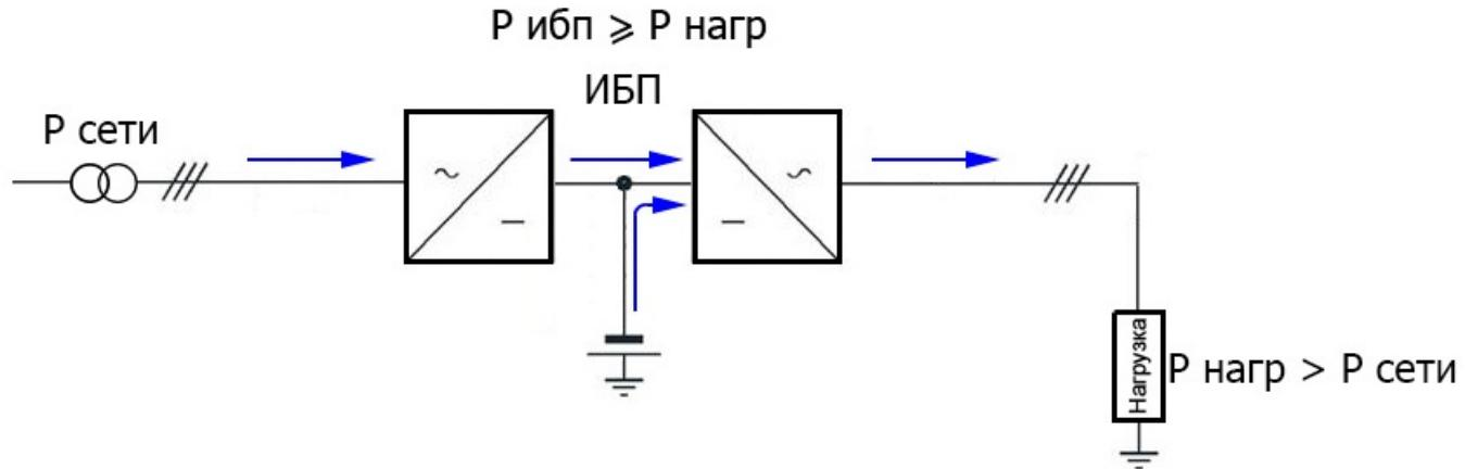
При токе нагрузки, превышающем разрешенный ток отбора от сети возможно использование ИБП большей мощности (равной или большей мощности нагрузки с учетом пусковых токов), чем разрешенная мощность отбора от сети. Таким образом при инсталляции ИБП необходимо установить уставку входного тока. И при токе нагрузке, превышающем разрешенный входной ток происходит добавление тока батарей к току выпрямителя.
