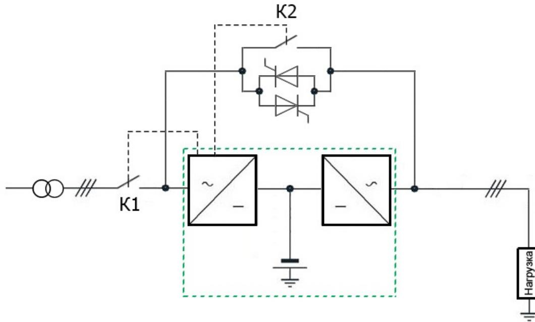
При пропадании входной сети происходит отключение контактора K1 и замыкание гибридного контактора K2. То есть входной выпрямитель переходит в режим работы инвертора и подключается в параллель к выходному инвертору.
