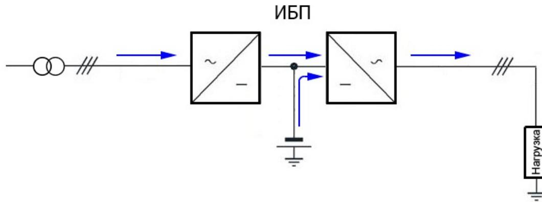
При провале фазного входного напряжения в диапазоне 220-140 В и нагрузке близкой к номинальной происходит добавление тока батарей к току выпрямителя.
